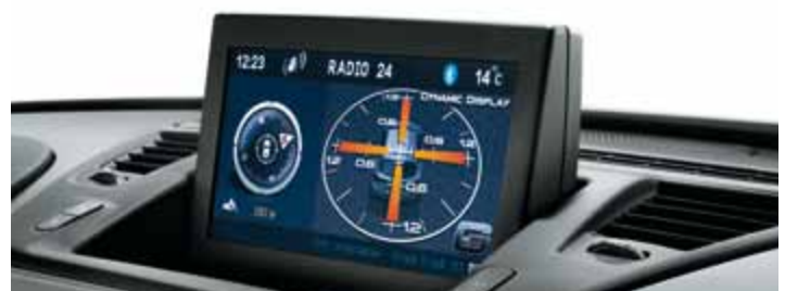
Rádio/navigační systém zobrazuje také hodnotu zrychlení vozu (podélného a příčného).
