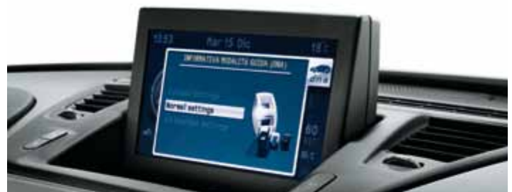
Alfa Romeo DNA komunikuje s rádiem/navigačním systémem. Zvolený režim je zobrazen na pop-up displeji.
