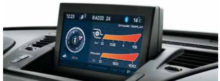
Rádio/navigační systém zobrazuje tlak přepřívání a výkon vyjádřený v procentech.
